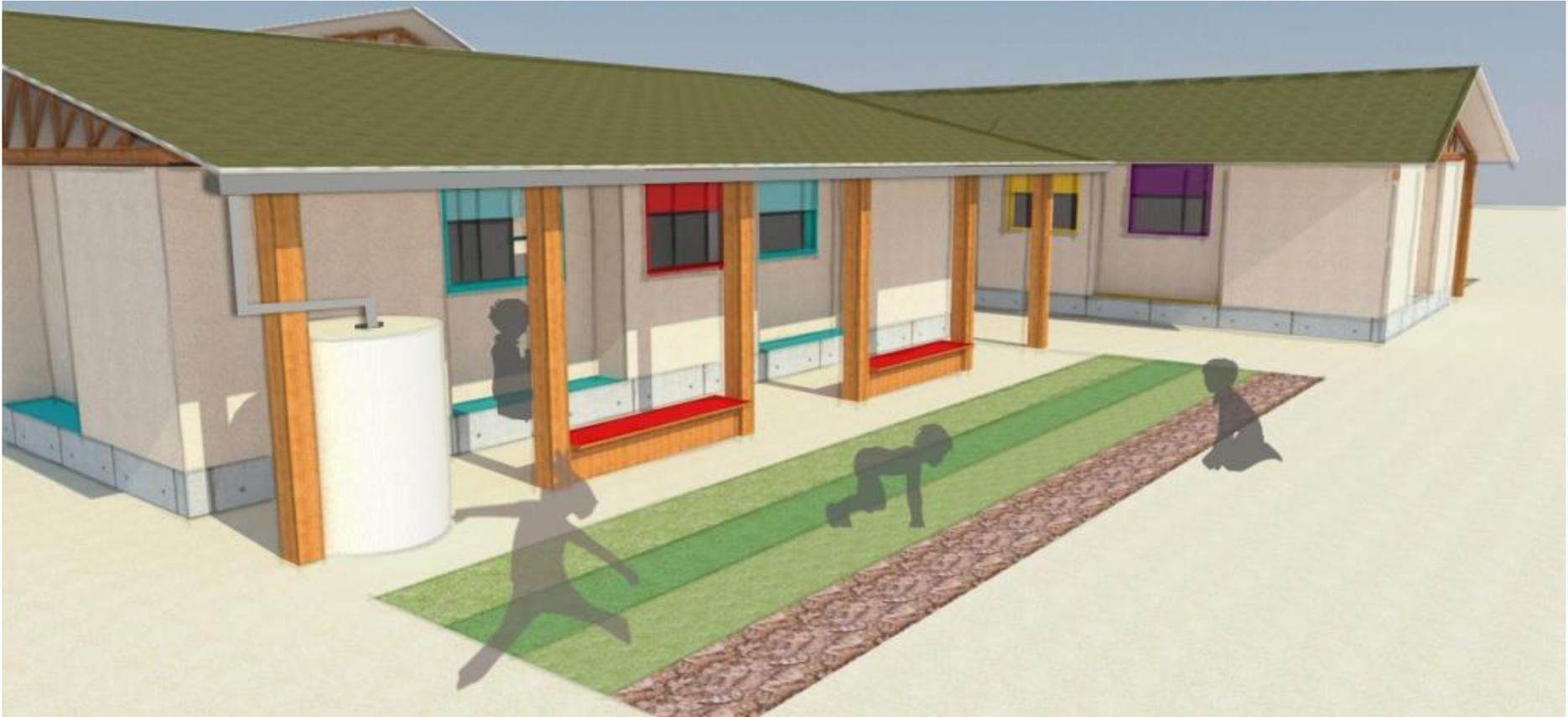
Imagen 09: Fachada lateral del Centro, mostrando bancos creados con los retranqueos y pilares de los porches, y también los huertos con sistema de captación de agua de las lluvias.
